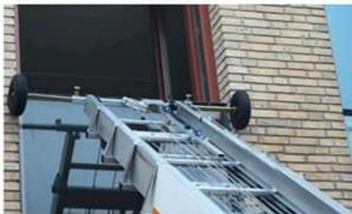
Ruedas de apoyo en cabezal
